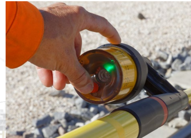
Direkte Rückmeldung vom Spannungsprüfer beim aktiven Einschalten
